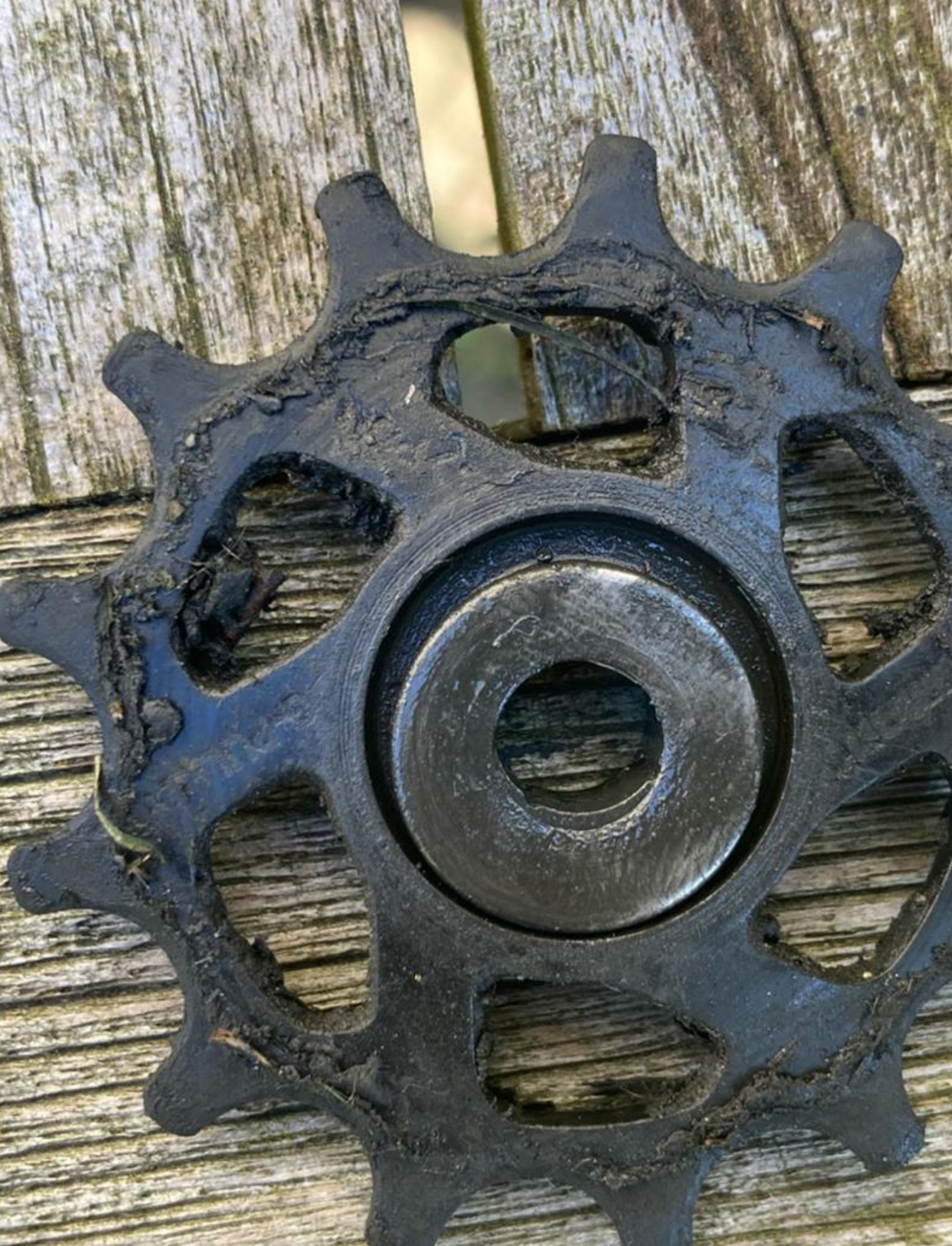
Kleines Problem, große Wirkung: Defektes Schaltungsradchen eines E-Bike
